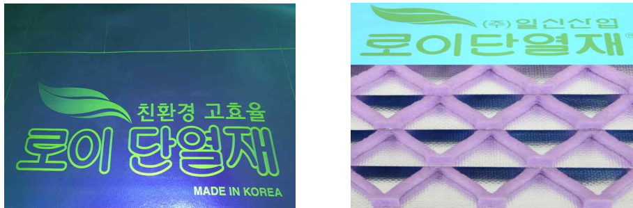
그림-1) 로이단열재® 표면색상(청색) 및 마킹상태와 대표적 내부단면 구조
